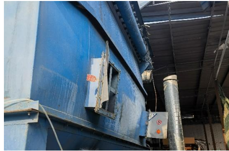
图 3-4 4#湿式除尘器爆炸后现场情况
