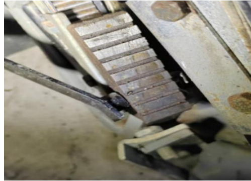
图 10 安全钳楔块钳口划痕
